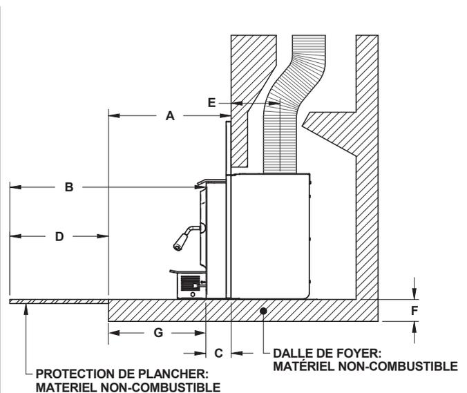
Figure 24: Protection de plancher aditionnelle - Installation non surélevée
