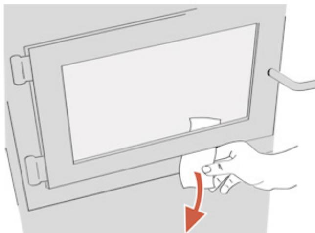
Figure 17: Vérification du joint de la porte
