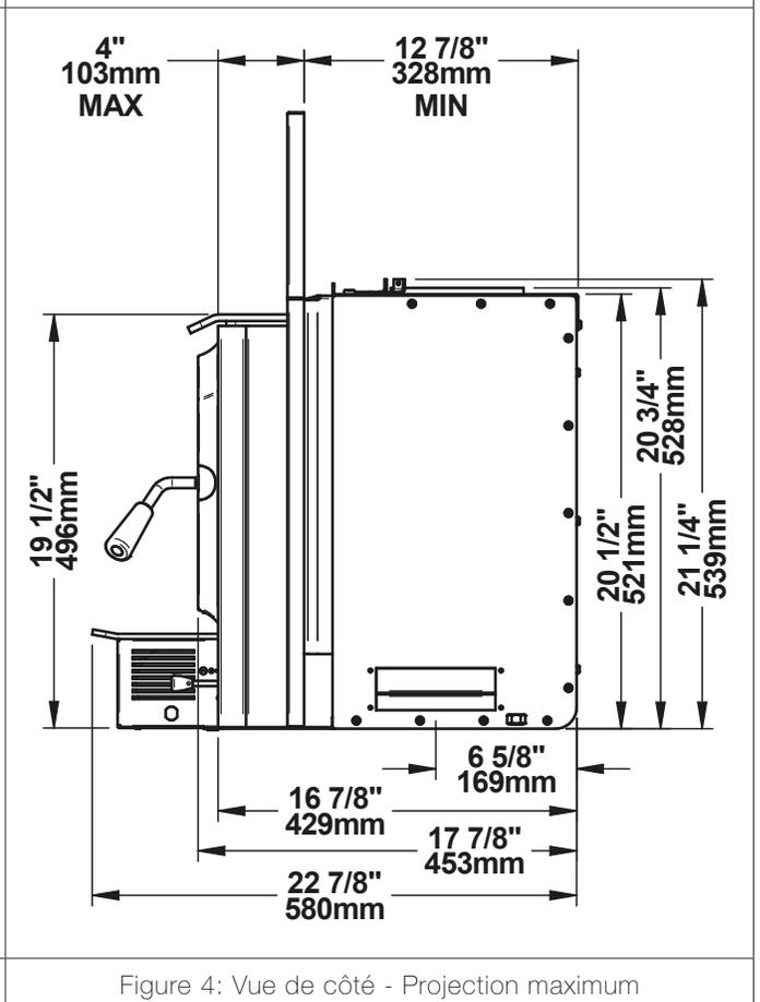
Figure 4: Vue de côté - Projection maximum
