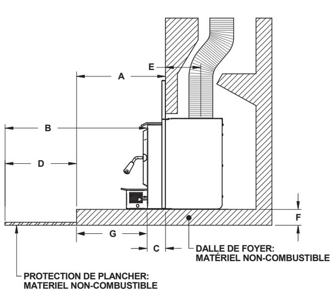
Figure 23: Protection de plancher aditionnelle - Installation surélevée
