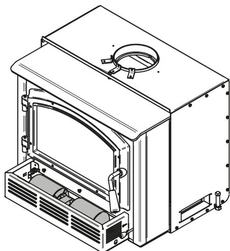
Figure 12: Emplacement du ventilateur
