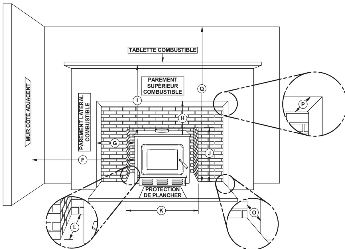
Figure 25: Ouverture de l'âtre et dégagements aux combustibles
