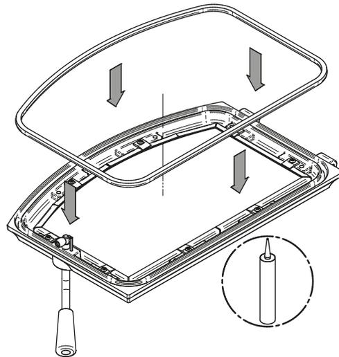
Figure 20: Joint d'étanchéité de la porte
