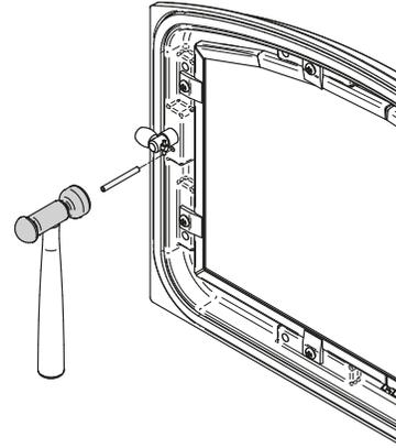
Figure 19: Installation de la goupille de retenue
